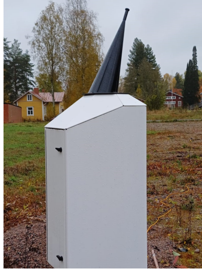
Figure 2. A termination hood (Vaisala CL61TERMHOOD) place on top of the CL61 in Hyytiälä Hyytiälä.
